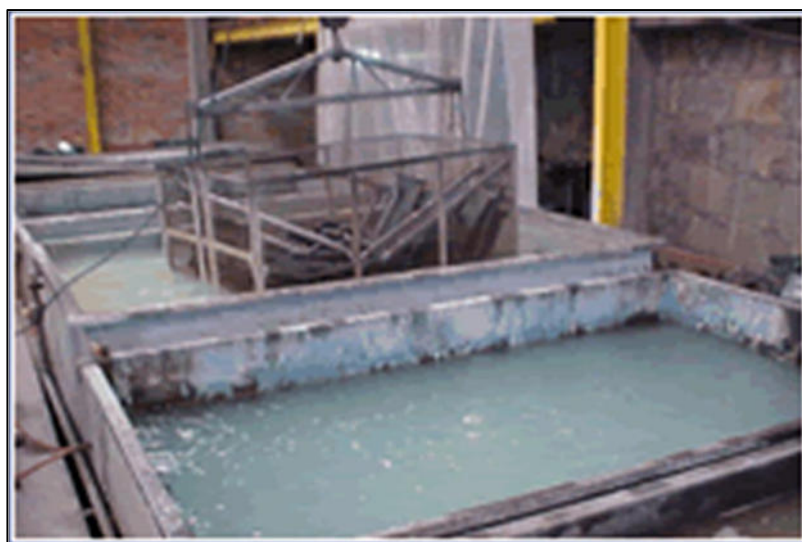
Figura 21: Processo de Fosfatização
